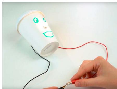
Befestige den Deckel wieder auf dem Becher. Jetzt kannst du deinen Stromprüfer dekorieren, z. B. ein Gesicht darauf malen oder auch Ohren ankleben. Halte nun die beiden Kabelenden an verschiedene Materialien und probiere selbst aus, welche Gegenstände Strom leiten.
