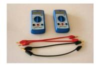
Mithilfe der Digitalmultimeter können Spannung, Stromstärke und Widerstand gemessen werden.
