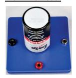
U=1,9V...2,15V Entladeschlussspannung: 1,4V-1,7V Max. Ladespannung 2,45V
