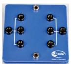
Mit Hilfe des Widerstandsmoduls können Parallelschaltungen verschiedener Widerstandsteckelemente realisiert werden. Reihenschaltungen werden durch das Hintereinanderschalten der Widerstandsmodule ermöglicht. Folgende Widerstandssteckelemente sind im Experimentiersystem enthalten:
