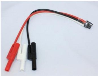
Hinweise zum Gebrauch des Akku-Adapterkabels finden Sie in Abschnitt 4.3 zur Innenwiderstandsbestimmung auf Seite 23.
