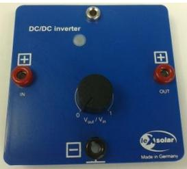
Max. Eingangsspannung:  $U_{\text{max}} = 6\text{V}$
