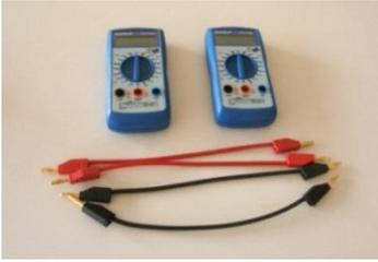
Mithilfe der Digitalmultimeter können Spannung, Stromstärke und Widerstand gemessen werden.
