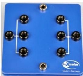
Mit Hilfe des Widerstandsmoduls können Parallelschaltungen verschiedener Widerstandssteckelemente realisiert werden. Reihenschaltungen werden durch das Hintereinanderschalten der Widerstandsmodule ermöglicht. Folgende Widerstandssteckelemente sind im Experimentiersystem enthalten:
