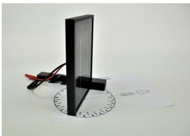
Solarmodul in 10Uhr-Stellung
