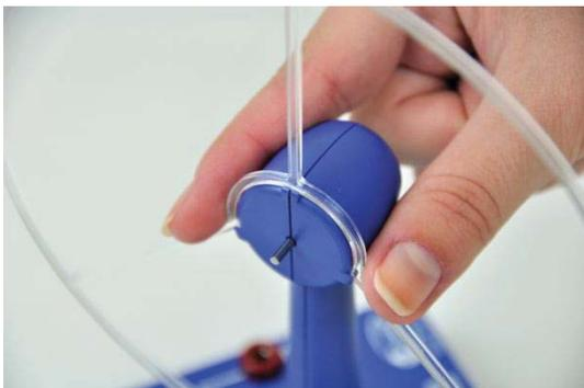
3) Anschließend wird der Windrotor auf die Welle des Windgenerators gesteckt.
