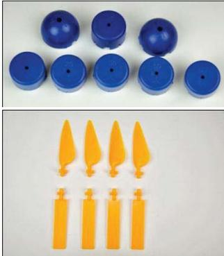
Aus den Bestandteilen können Rotoren mit 2, 3 oder 4 Rotorblättern mit einem flachen Profil oder einem optimierten Profil zusammensetzt werden. Der 4-fach Nabeneinsatz ist in einem Anstellwinkel von 25° und der 3-fach Einsatz in den Anstellwinkeln 20°, 25°, 30°, 50° und 90° vorhanden.
