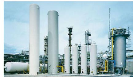
Abb.2.15: Steam-Reformer, Anlage zur Erzeugung von Wasserstoff aus Erdgas<sup>17</sup>
