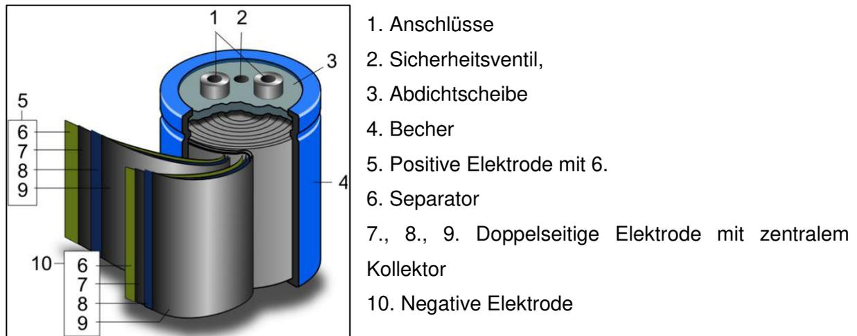
Abb.2.14: Schematischer Aufbau eines Supercap-Kondensators <sup>16</sup>
