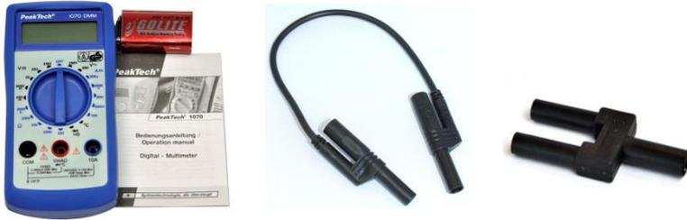
Das Digitalmultimeter wird je nach Versuch zur Bestimmung von Spannung, Strom oder Widerstand verwendet. Bei versehentlichem Überstrom kann im Nachhinein die Sicherung des Gerätes ausgetauscht werden, um die Funktionalität bei der Strommessung wieder herzustellen. Es empfiehlt sich allerdings in den Experimenten bei der Strommessung den 10A-Messbereich zu nutzen (Achtung: Dann Verwendung der dritten Buchse unten rechts).
