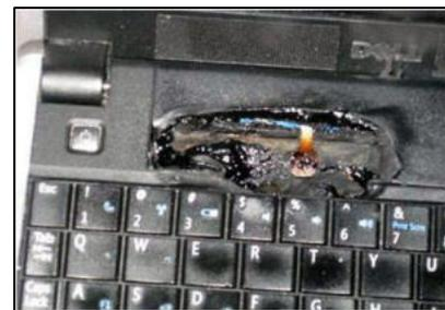
Abb.2.11: Folgen eines Lithium-Akku-Brandes<sup>15</sup>
