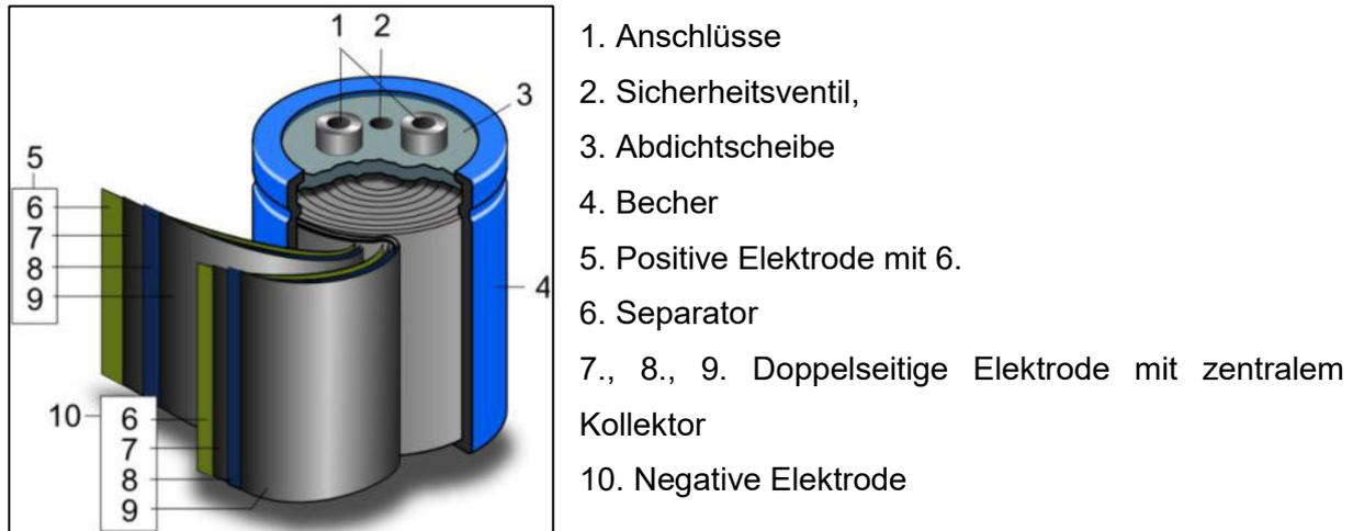
Abb.2.14: Schematischer Aufbau eines Supercap-Kondensators <sup>16</sup>
