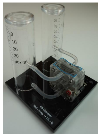
Abb: Elektrolyseur auf Grundplatte mit angeschlossenen Vorratsgefäßen
